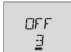
2. Затем газоанализатор снова включается и выполняет обратный отсчет калибровки (**CAL**). Продолжайте удерживать кнопку
