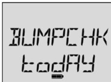
Для перехода в нормальный режим необходимо выполнить экспресс-тест. Подайте газ на сенсоры. Проверьте срабатывание световой, звуковой и вибрационной сигнализации. После отключения подачи газа газоанализатор на короткое время остается в состоянии тревоги, пока остатки газа не покинут сенсоры.
