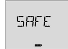
Газоанализатор поставляется с отключенной функцией **Safe Mode** (Безопасный режим).
