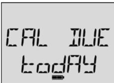
Если калибровка просрочена и включена функция **Force Calibration When Overdue** (Принудительная калибровка при превышении срока), то для перехода в нормальный режим необходимо выполнить калибровку. См. раздел [Калибровка](#).
