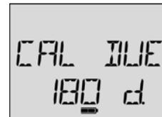
**Сенсор с неудачной и просроченной калибровкой:** если определение диапазона измерения для сенсора завершилось неудачей и срок калибровки истек, отображаются следующие три экрана.
