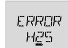
**Автоматическое определение диапазона измерений:** если целевой газ не соответствует ожидаемым значениям, отображается сообщение об ошибке.
